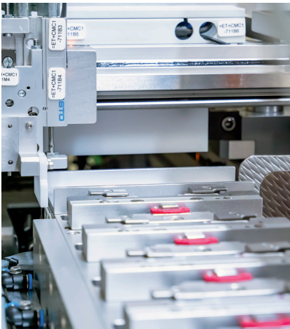
Schneidestation: Sie macht aus dem Kartenmaterial einzelne Teststreifen und sortiert Fehlstellen vollautomatisch aus.
