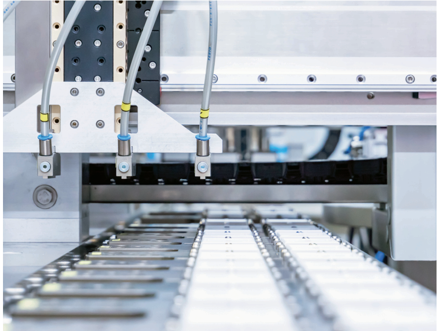
Montagezeit 750 ms: Voraussetzung dafür ist der schnelle Transport von Einzelteilen – hier der Unterschalen. © MA micro automation
